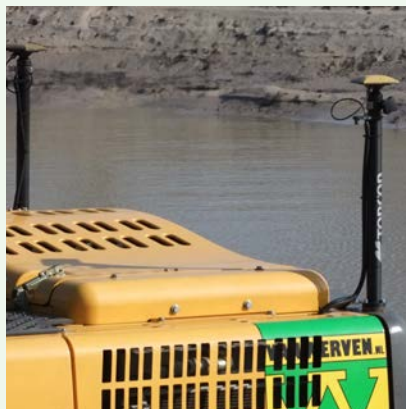
Omschrijving GPS besturingssysteem Type 2D/3D Bijzonderheden Voor shovel, kraan en bulldozer Bestelnummers 14024/14026
