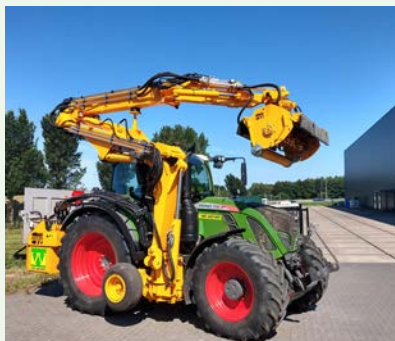
Omschrijving Trekker met herder en klepelmaaier Werkbreedte 1,50 m Bestelnummers 11132
