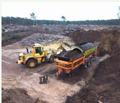
Omschrijving Mobiele trommelzeef Type Doppstadt SM 620 Bijzonderheden Alleen te huren i.c.m. kraan of shovel Trommelmaat 10 t/m 50 mm Bestelnummers 15000
