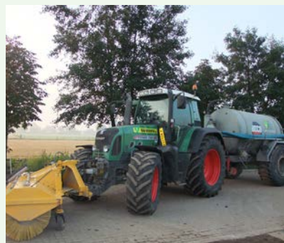
Omschrijving Trekker met waterwagen Inhoud 5,00 m 3 Breedte 2,60 m Bestelnummers 11030 ICM rolbezem 11031/11095
