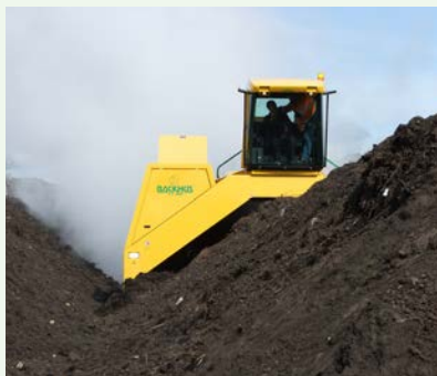
Omschrijving Backhus Compostomzetter Gewicht 12,50 ton Breedte 6,40 m Hoogte 4,75 m Bijzonderheden Bestelnummers 15004
