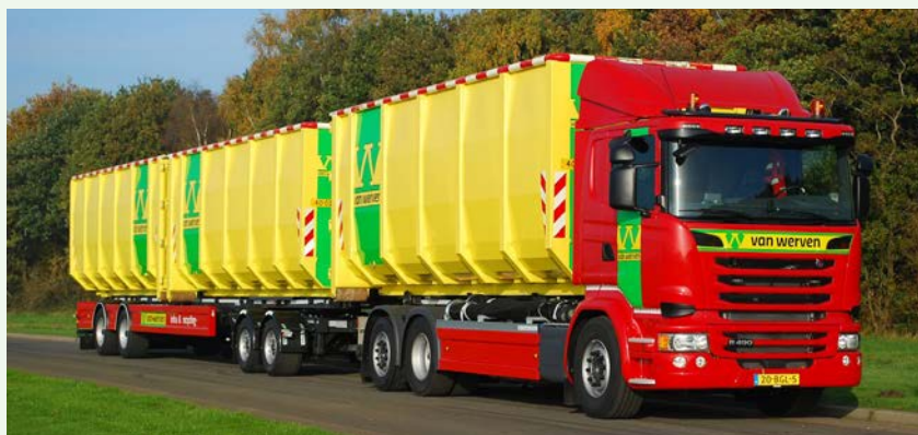
Omschrijving Vrachtwagen containerauto met weeginstallatie en containeraanhanger Aandrijving 6x2 Inhoud Bijzonderheden LZV Bestelnummers 11526
