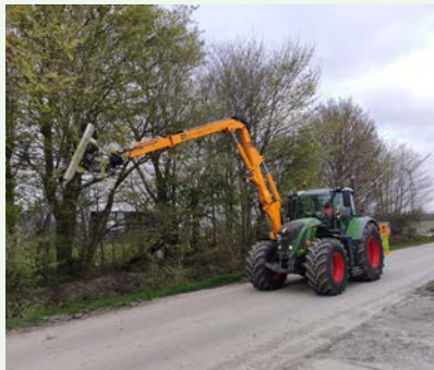
Omschrijving Trekker met takkenzaag Werkbreedte 2,00 m Doorsnede tot 16 cm Bestelnummers 11144
