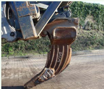
Omschrijving Bijzonderheden Verreiker Kranen Laadschop Bestelnummers Vaste tandripper Voor lostrekken slakkenwegen ✓ 12020
